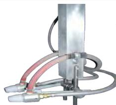
Le support de buses fixe avec bras ajustable libère les mains de l'opérateur lors du sablage des pièces ou peut être synchronisé avec une table rotative motorisée afin d'obtenir un procédé de traitement semi-automatisé.
