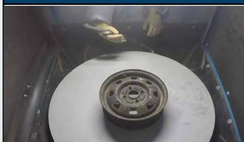
Standard avec vitesse ajustable et capacité de charge jusqu'à 500 lb, les tables rotatives motorisées permettent de faciliter la manipulation des pièces durant le sablage manuel ou peuvent être synchronisées avec un support de buses fixe ou une tête de sablage rotative afin d'obtenir un procédé de sablage semi-automatisé.
