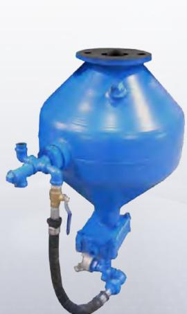
Tous les cabinets à pression ISTblast sont équipés d'un vaisseau sous pression de 1.3 pied cube muni d'une valve de dosage AR-7 pour en définir l'efficacité. Cette valve permet la mise au point de l'écoulement des médias au point de mélange où l'abrasif rencontre le flux d'air.
